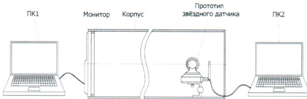
Рис. 1. Схема стенда для тестирования программно-математического обеспечения звёздного датчика
